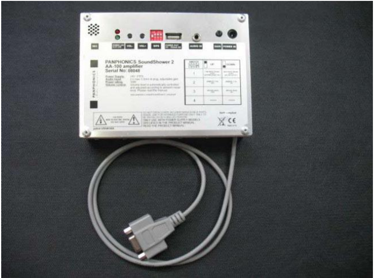
Рис. 17. Тыльная сторона усилителя AA100e и 0,8 м. кабель с D-разъемом
