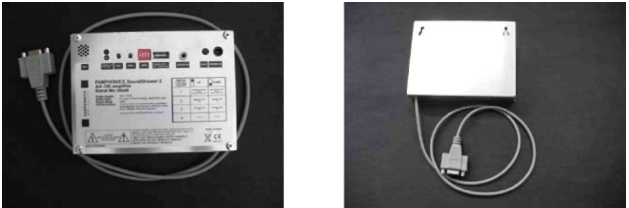
Рис. 6. А100е внешний усилитель, лицевая и фронтальная сторона
